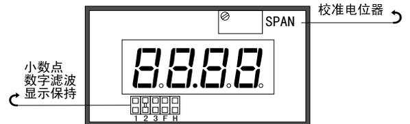
3. 用“-”字螺丝刀旋动电位器调整显示值,顺时针旋动,数字增大,逆时针旋动,数字减小。注意:电位器所能调整的范围是有限的,当调整范围比较大,调不到位时,请咨询供货商。
